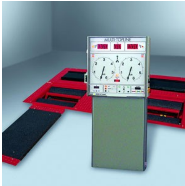
Fig. 1 Foto van de teststraat bestaande uit een spoorplaat, een remmen- en schokdempertestbank.
