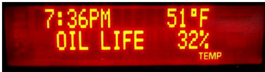
Figuur 11: Voorbeeld van een display voor de weergave van de olie-kwaliteit (foto: Daimler).
