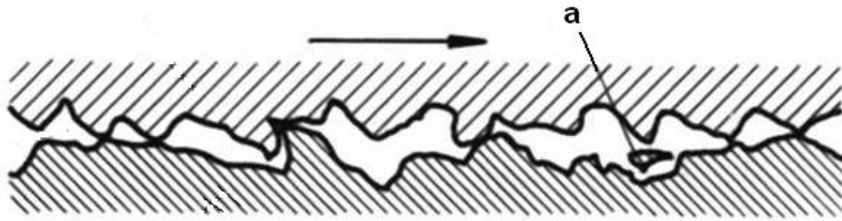
Figuur 1: Bij stilstand van de glijlagers is er metaal op metaal contact. Door de grote wrijving ( \mu groter dan 0,3) is er ook sprake van grote slijtage. Stukjes metaal kunnen afbreken (a).
