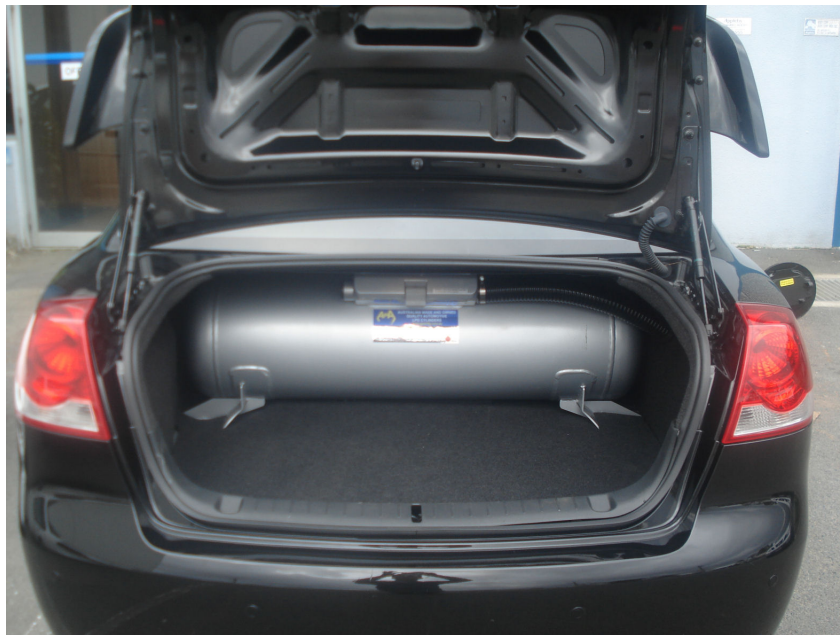
Figuur 1: Deze LPG-tank (Commodore) heeft een watercapaciteit van 94 liter en heeft een LPG-vulcapaciteit van 75 liter (foto:internet South East LPG Conversions).
